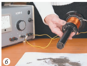
Рис. 6.4. После замыкания цепи железные опилки притягиваются к сердечнику (а); после размыкания цепи — отпадают от него (б)
