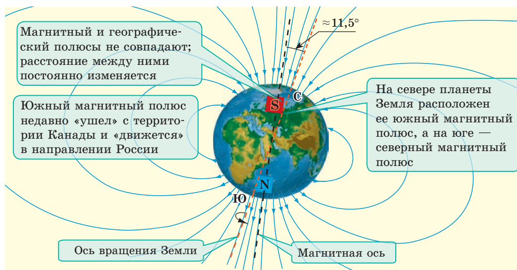
Рис. 2.8. Схема расположения магнитных линий магнитного поля планеты Земля
