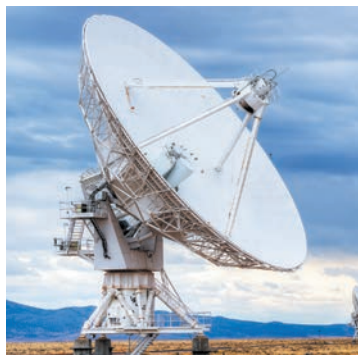
Рис. 21.3. Излучение узкого направленного пучка ультракоротких радиоволн и прием отраженного сигнала обеспечивает параболическая антенна радиолокатора
