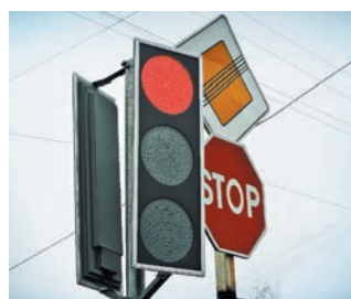
Рис. 9.3. Сигналы современных светофоров хорошо заметны даже при ярком солнце. В таких светофорах лампы накаливания заменены светодиодными
