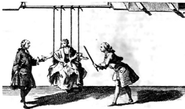
Рис. 40.6. Опыт, демонстрирующий существование проводников и диэлектриков (гравюра середины XVIII в.). Женщина сидит на качелях, подвешенных на шелковых нитях. Мужчина, стоящий справа, приближает наэлектризованную стеклянную палочку к руке женщины, а стоящий слева прикасается к ее другой руке — появляется искра
