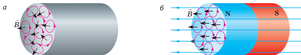
Рис. 5.7. Механизм намагничивания тел согласно гипотезе Ампера: а — круговые токи ориентированы беспорядочно, тело не намагничено; б — круговые токи ориентированы в определенном направлении, тело намагничено
