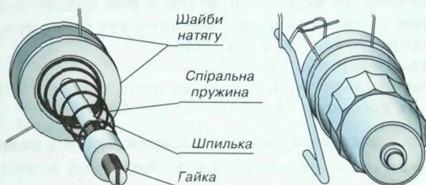
Мал. 76. Регулятори натягу верхньої нитки
