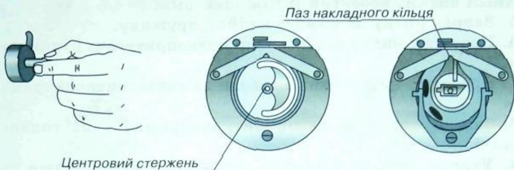
Мал. 82. Установлення шпульного ковпачка у човниковий пристрій
