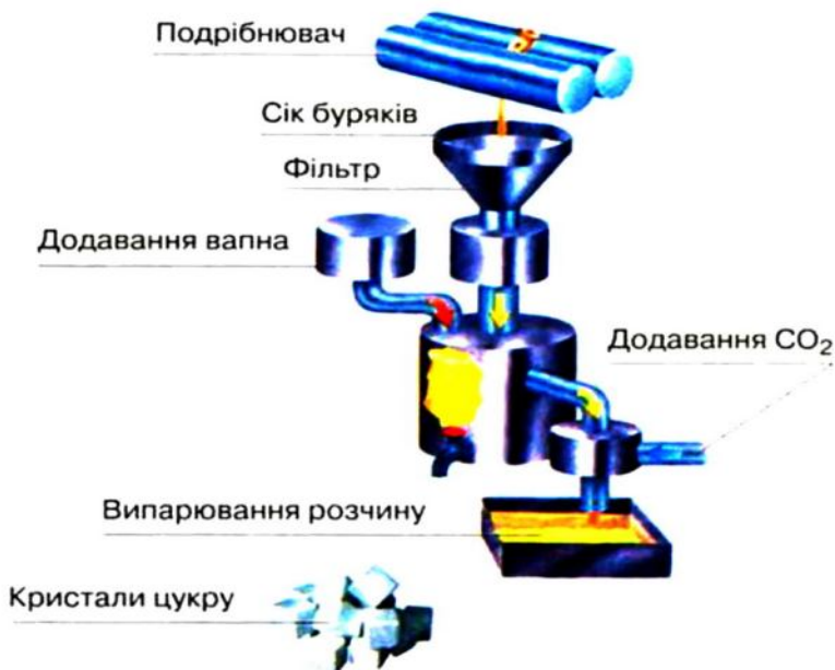
Мал. 57. Схема виробництва цукру
