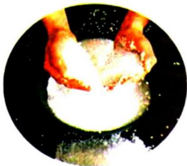
Мал. 48. Промисловий поліетилен випускають у вигляді гранул (крихти)
