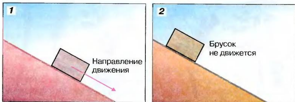
Рис. 86. 1 — движение по наклонной плоскости под действием сил тяжести и трения; 2 — сила трения зависит от свойств трущихся поверхностей
