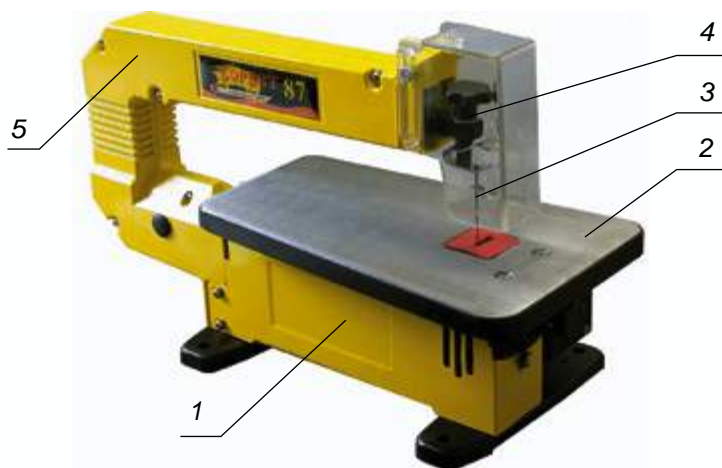
Рис. 65. Электрический лобзик: 1 – электрический двигатель; 2 – распиловочный столик; 3 – пилочка; 4 – винты крепления пилочки; 5 – корпус лобзика
