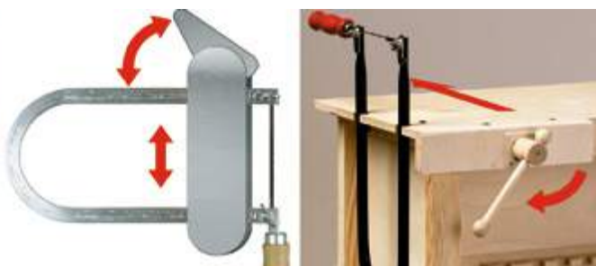
Рис. 56. Приспособление для стягивания рамки лобзика
