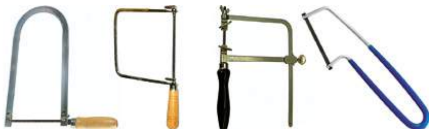
Рис. 52. Конструкции лобзиков
