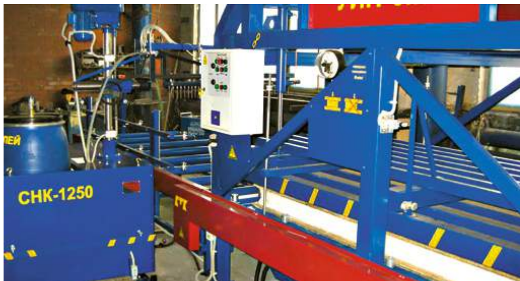
Рис. 29. Автоматическая линия для изготовления фанеры
