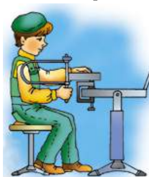
Рис. 58. Положение туловища при выпиливании
