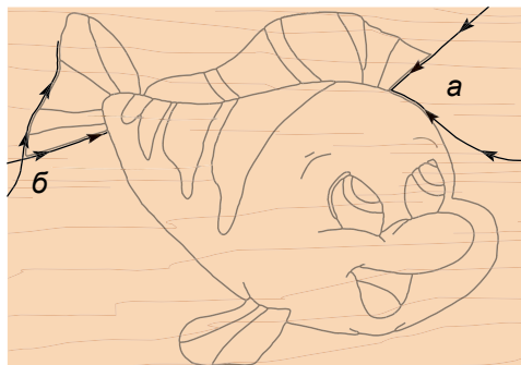
Рис. 62. Выпиливание острых углов: а – внутренних, б – внешних
