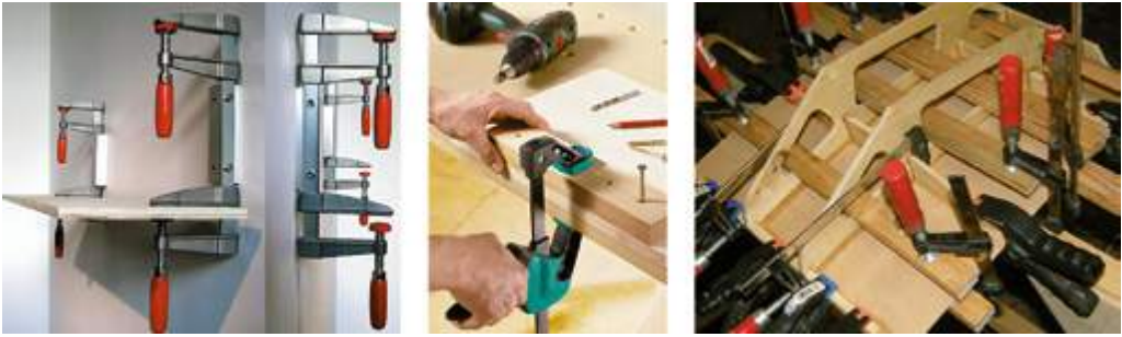
Рис. 106. Уплотнение склеенных деталей струбцинами
