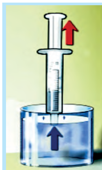
Рис. 27.4. Вода движется за поршнем насоса, потому что ее туда «втискивает» сила атмосферного давления
