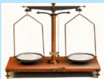
Рис. 19.2. Массу тела определяют с помощью рычажных весов
