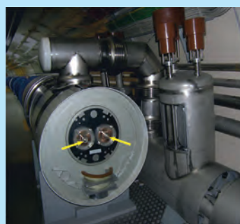
Рис. 37.9. Система охлаждения и две трубки, по которым двигаются протоны
