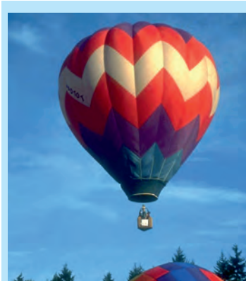
Рис. 29.5. Монгольфьер заполняют горячим воздухом
