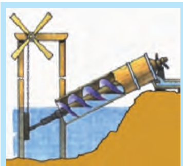
Рис. 27.6. Винт Архимеда позволяет перекачивать пульпу (смесь глины и воды)
