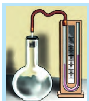
Рис. 27.2. Открытый жидкостный манометр
