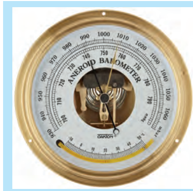
Рис. 26.8. Барометр-анероид. Принцип действия
