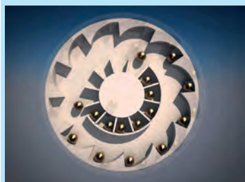
Рис. 35.4. Проект вечного двигателя
