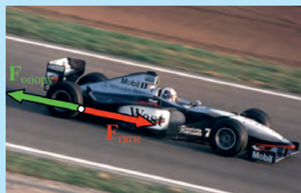
Рис. 21.10. Сила тяги ускоряет автомобиль, а силы трения и сопротивления воздуха уменьшают его скорость
