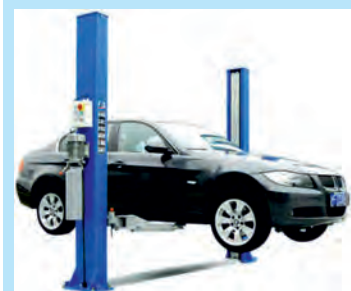
Рис. 27.10. Гидравлический подъемник
