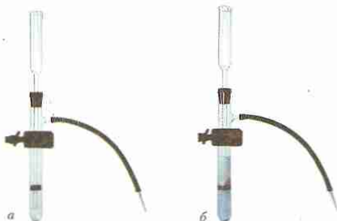
Рис. 44. Прибор для получения газов (а) и добывание углекислого газа в нём (б)
