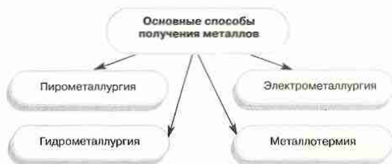
Рис. 85. Схема классификации способов получения металлов
