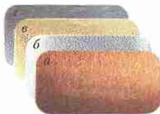
Рис. 62. Пластины, изготовленные из разных металлов: меди (а); алюминия (б); золота (в); цинка (г)
