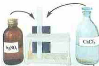
Рис. 20. Качественная реакция на хлорид-ион
