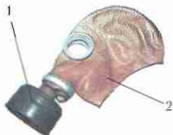
Рис. 14. Противогаз: 1 — коробка с адсорбентом; 2 — резиновый шлем
