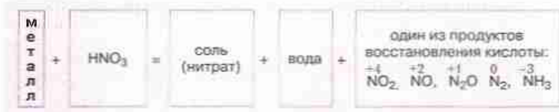
Рис. 30. Схема взаимодействия нитратной кислоты с металлами
