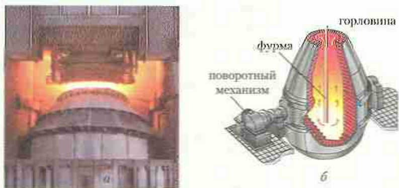
Рис. 92. Кислородный конвертер: внешний вид (а), схема строения (б)
