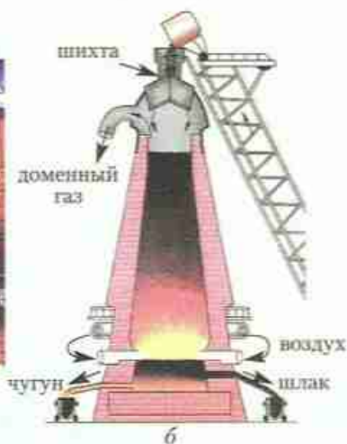
Рис. 90. Домна: внешний вид (а) и схема строения (б)
