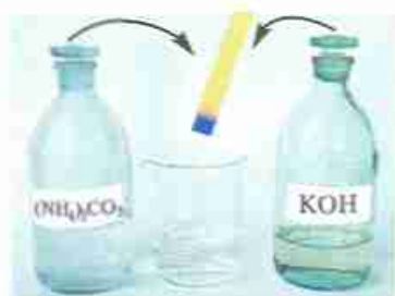
Рис. 19. Качественная реакция на ион аммония
