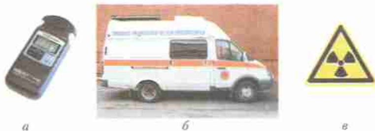
Рис. 74. Дозиметр (а), мобильная химико-радиологическая лаборатория (б), предупреждающий знак (в)
