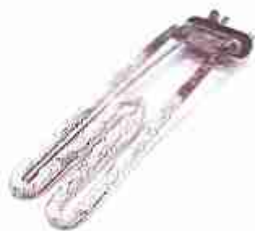
Рис. 77. Нагревательный элемент, покрытый слоем накипи
