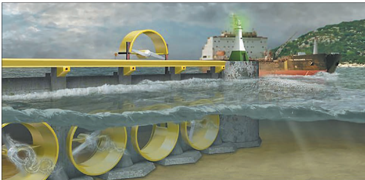
Мал. 3. Принцип роботи припливної електростанції.
