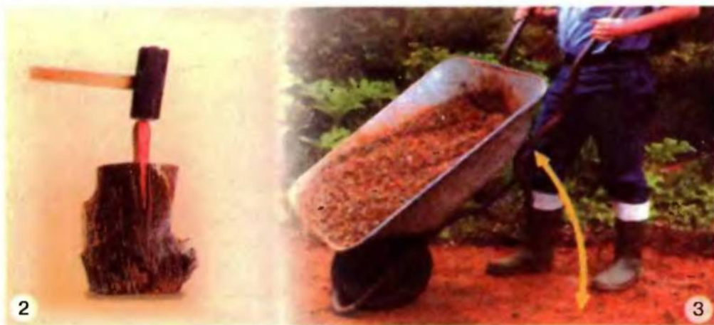
Мал. 105. Приклади використання важелів (1), клина (2), колеса (3)
