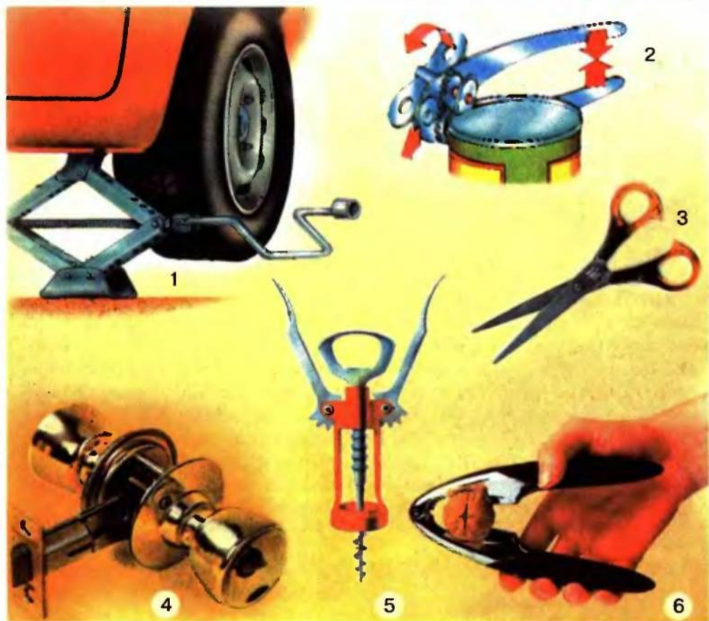
Мал. 109. Приклади складних механізмів 1 – домкрат; 2 – консервний ніж; 3 – ножиці; 4 – замок; 5 – штопор; 6 – горіходавка
