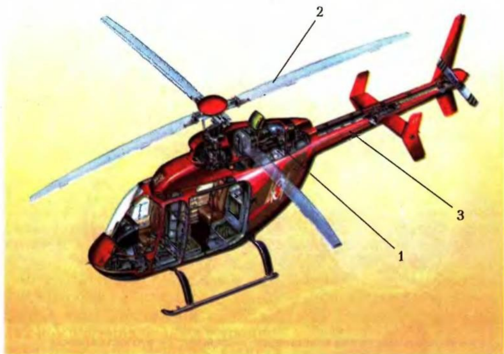
Мал. 116. Основні частини рукотворної системи – гелікоптера: 1 – двигун; 2 – робочий орган; 3 – механізм
