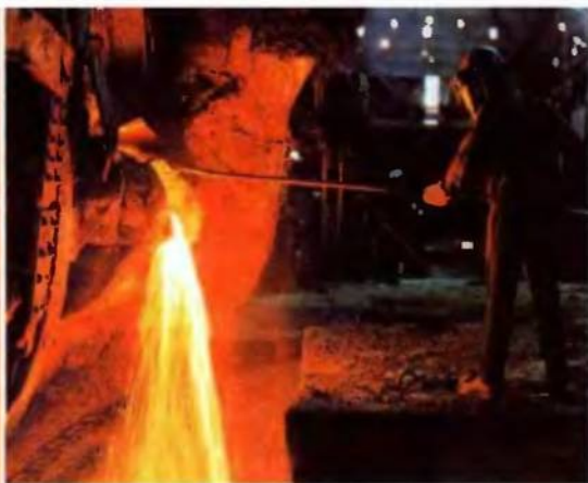
Мал. 146. Плавлення чавуну
