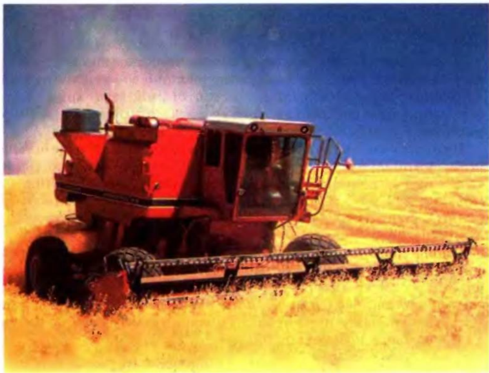
Мал. 118. Зернозбиральний комбайн – поєднання кількох машин
