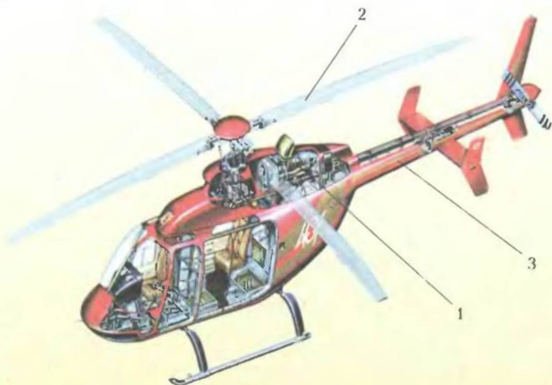
Рис. 116. Основные части рукотворной системы – вертолета: 1 – двигатель; 2 – рабочий орган; 3 – механизм
