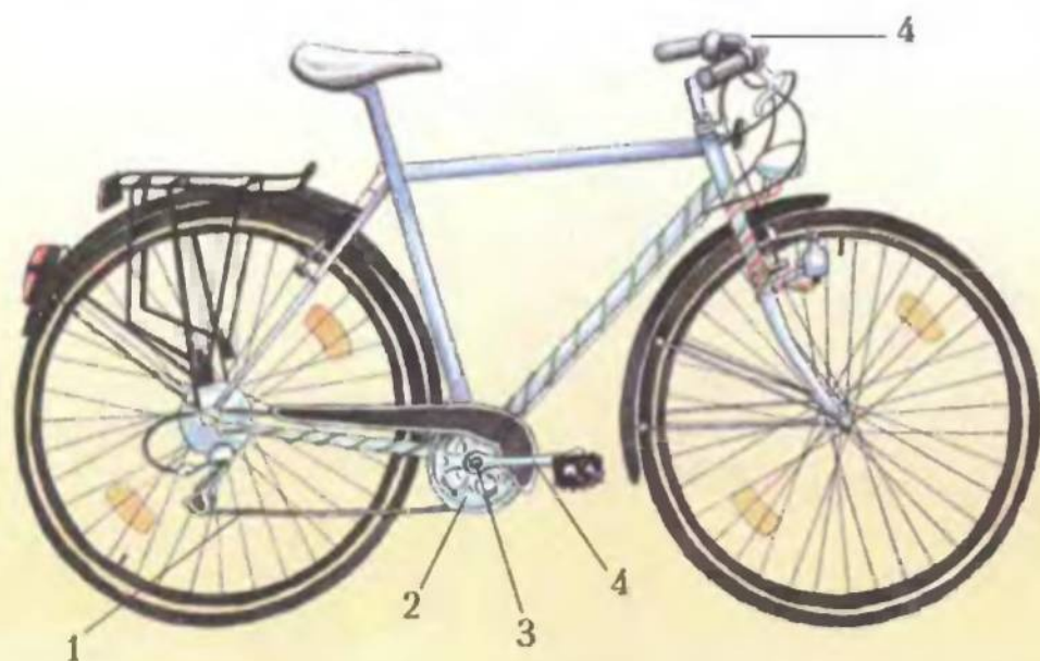
Рис. 117. Механизм велосипеда: 1 – цепь; 2 – зубчатое колесо; 3 – ось; 4 – рычаги
