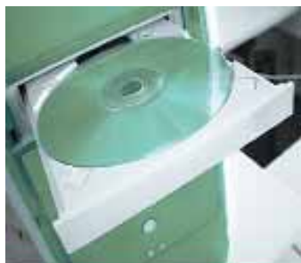
Rys. 2.4. Optyczny dysk w urządzeniu do odczytywania/nagrywania
