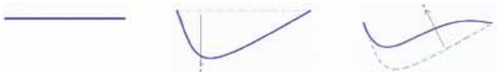
Rys. 3.11. Kolejność budowania krzywej z dwoma łukami
