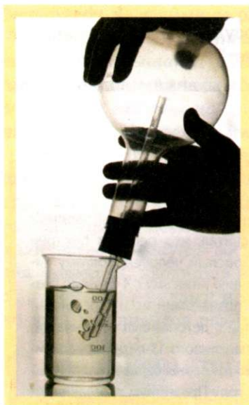
Рис. 2.30. При нагревании воздух в колбе расширяется и часть его выходит из колбы — это видно по пузырькам воздуха, выходящим из трубки
