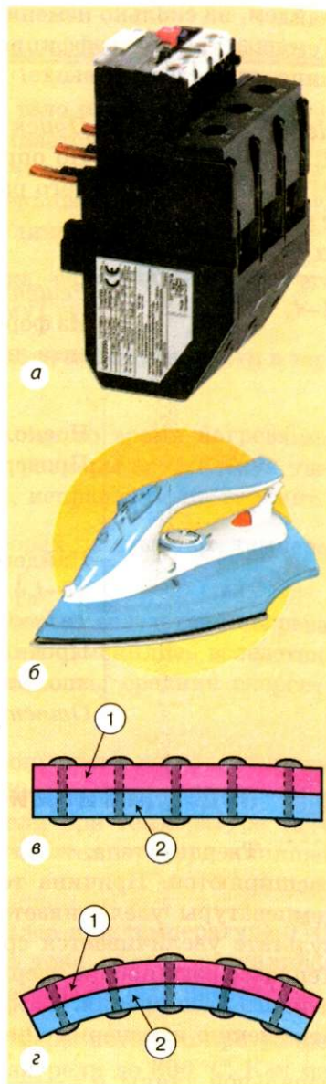
Рис. 2.33. Для изготовления автоматических предохранителей (а), для автоматического включения и выключения нагревательных приборов (б) широко используются биметаллические пластинки (в). Один из металлов при увеличении температуры расширяется намного больше, чем другой, в результате этого пластинка изгибается (г) и электрическая цепь размыкается (или замыкается)
