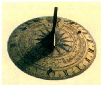
Рис. 3.15. Принцип действия солнечных часов базируется на том, что тень от вертикально расположенного объекта, освещенного солнцем, изменяет свою длину и расположение в течение дня
