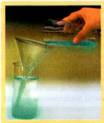
Рис. 2.15. Воспользовавшись воронкой с длинным носиком, можно аккуратно налить раствор медного купороса на дно стакана с водой
