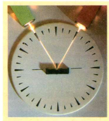
Рис. 3.23. Демонстрация обратимости световых лучей с помощью зеркала. Видно, что отраженный луч идет по пути падающего луча
