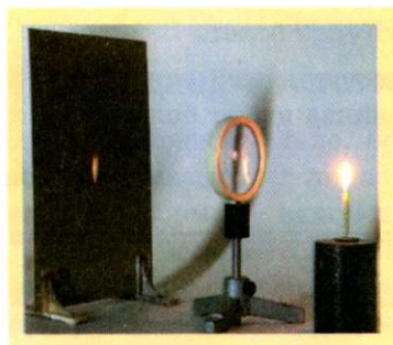
Рис. 3.59. Получение изображения пламени свечи с помощью собирающей линзы
