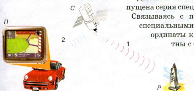
Рис. 4 — Схема работы системы GPS. С — спутник; P — репер; П — пользователь прибора GPS. (1) — радиосигнал для связи с репером; (2) — радиообмен с пользователем
