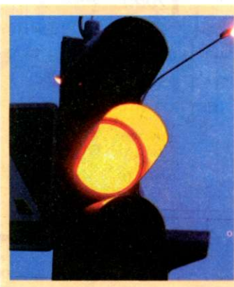
Рис. 3.4. Сигналы современных светофоров хорошо видны даже тогда, когда солнце светит ярко. В таких светофорах лампы накаливания заменены светодиодами
