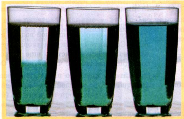
Рис. 2.16. Наблюдение явления диффузии в жидкостях: в результате диффузии резкая граница между раствором медного купороса и водой постепенно исчезает
